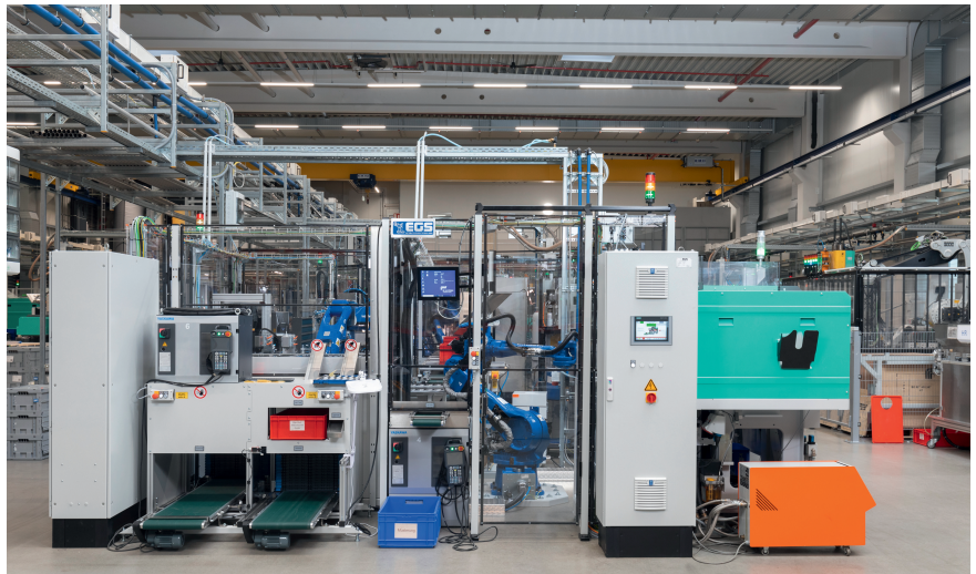
Bild 2. Die Fertigungsinsel mit sechs Motoman-Robotern, mehreren Handhabungs- und Prüfstationen und einem Palettiersystem produziert mehrere Millionen Kunststoff-Hybridstecker im Jahr. © EGS
