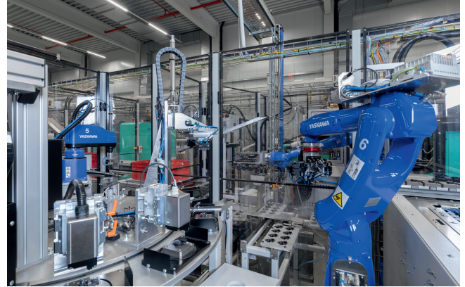
Bild 4. Der Motoman GP7 ist der taktzeitkritische Roboter, denn er bestückt nicht nur den Rundscharltisch, sondern legt die Fertigteile abschließend in Trays ab. © EGS
